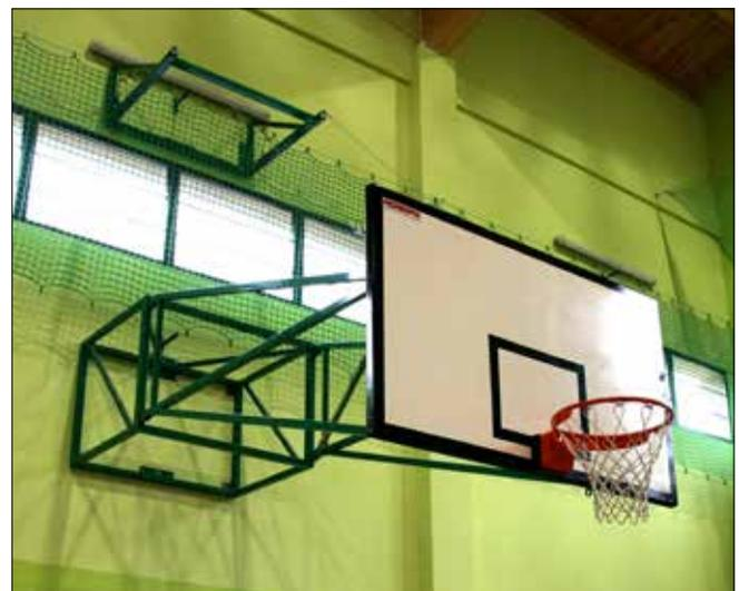
Ферма с фиксированной частью. Применяется в случае если на стене появляется препятствие (напр. защитные сетки)
